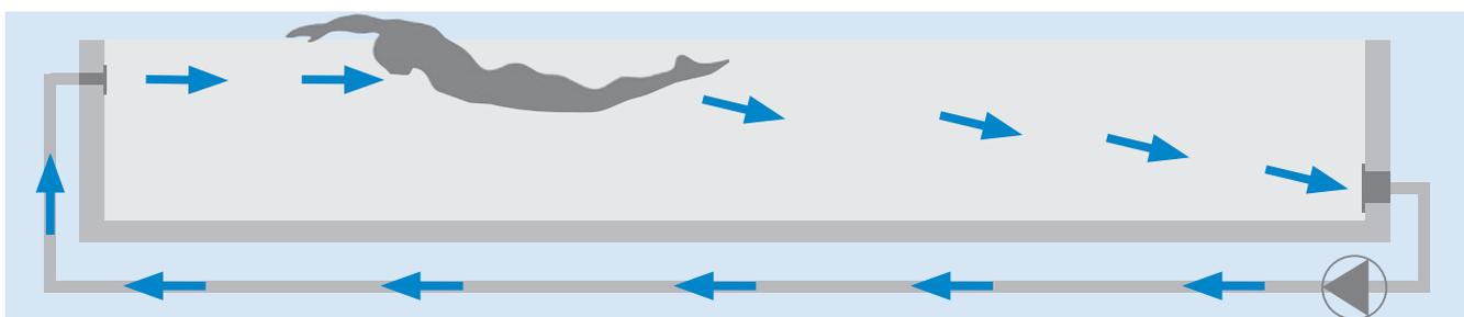
**Neu von Ospa:** Das ganze Becken ist ein kraftvoller Schwimmkanal. Die stetige Strömung im gesamten Becken entsteht dadurch, dass das Wasser an der gegenüberliegenden Seite des Beckens angesaugt wird. Die kraftvolle Strömung bis
